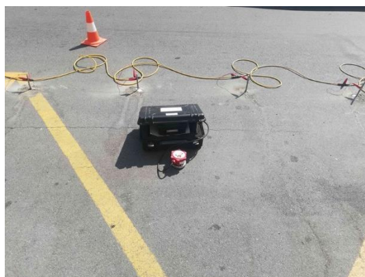
Figura 230. Foto indagine HVSr sottostazione di “Degola”.
