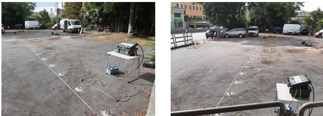
Figura 245. Foto indagine ERT sottostazione di "Carlini".
