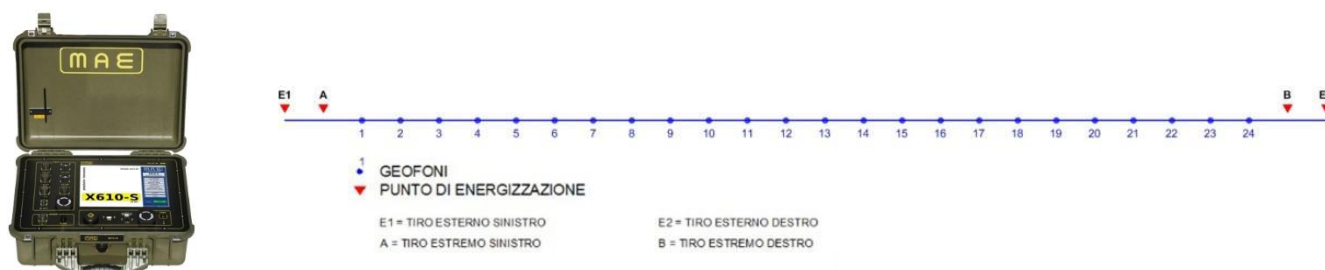
Figura 1. Indagine MASW. Esempio di configurazione sorgente-ricevitori per un tipico rilievo.
