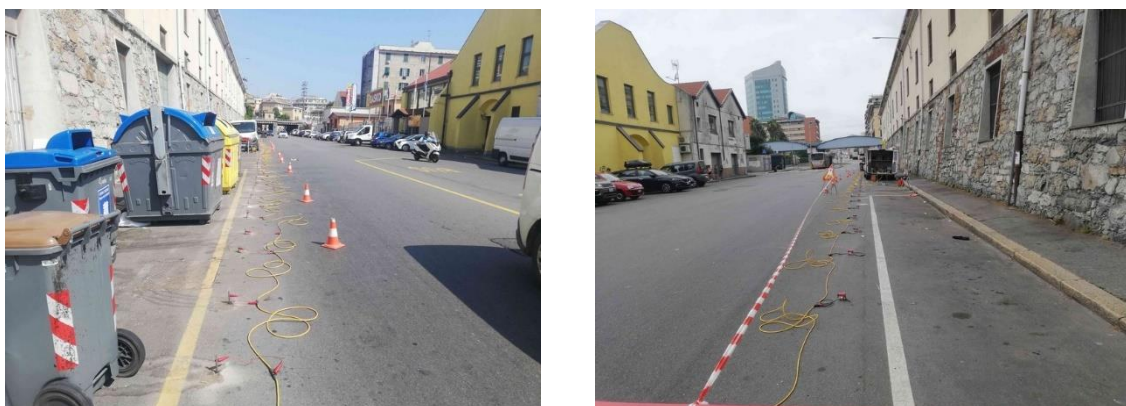
Figura 269. Foto indagine ERT sottostazione di "Degola".
