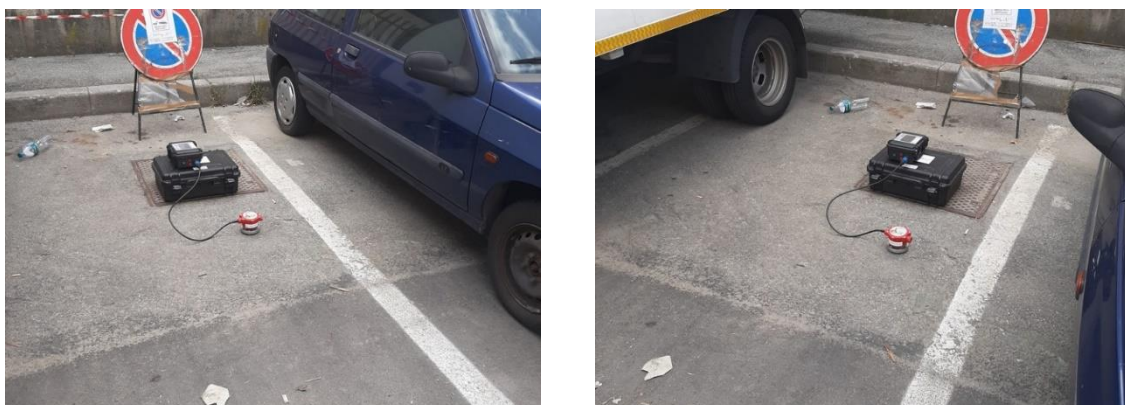
Figura 194. Foto indagine HVSR sottostazione di "Campi".
