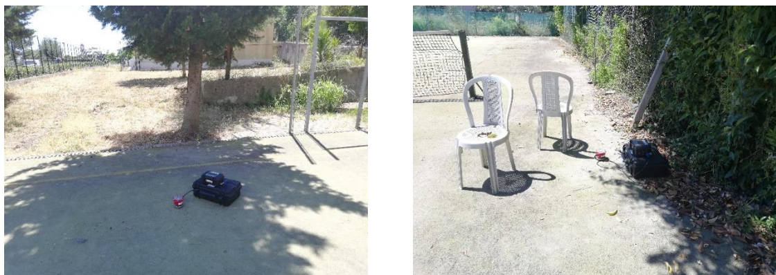
Figura 48. Foto indagini HVSR deposito di "Levante".
