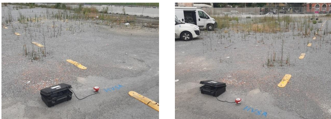
Figura 200. Foto indagine HVSR sottostazione di "via Merano".
