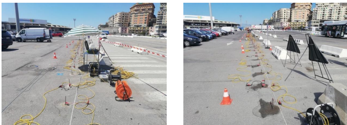
Figura 257. Foto indagine ERT sottostazione di “Kennedy”.
