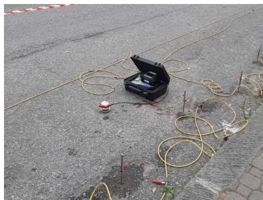
Figura 164. Foto indagine HVSR sottostazione di "Gottardo".
