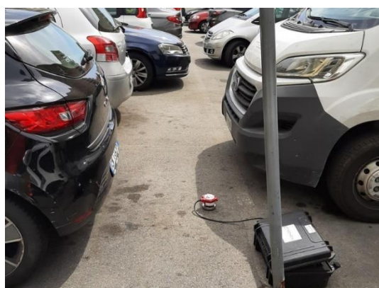
Figura 218. Foto indagine HVSr sottostazione di "Sardegna".
