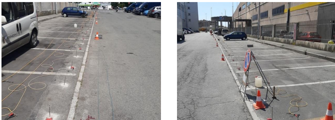
Figura 302. Foto indagine SRT sottostazione di "Campi".
