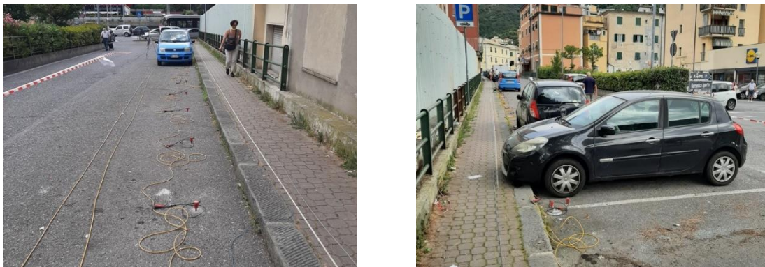
Figura 104. Foto indagine MASW sottostazione di "Gottardo".
