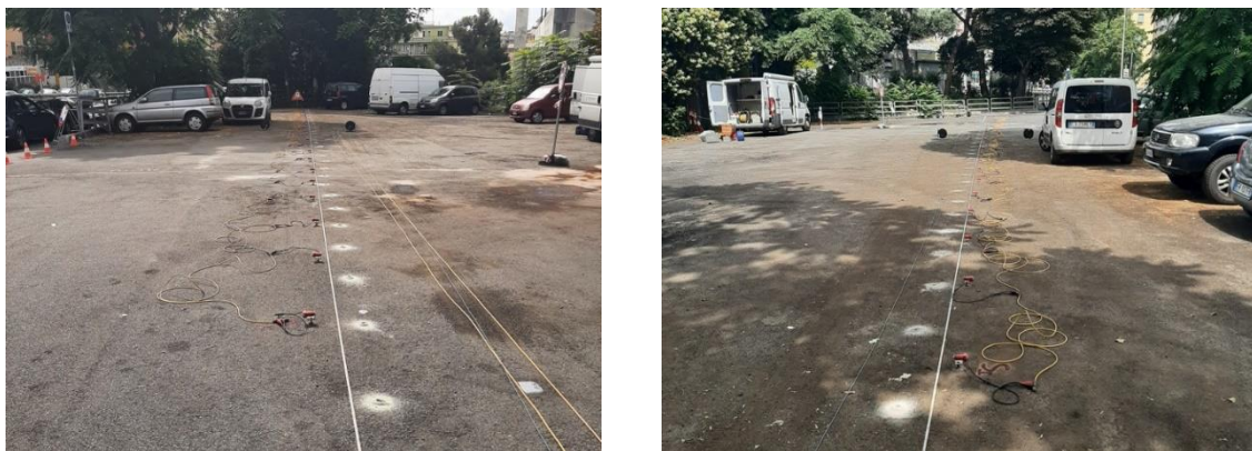
Figura 290. Foto indagine SRT sottostazione di "Carlini".
