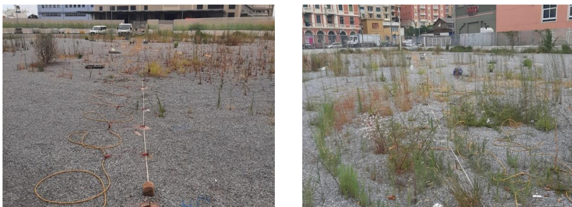
Figura 254. Foto indagine ERT sottostazione di "via Merano".
