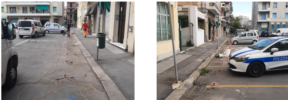
Figura 124. Foto indagine MASW sottostazione di “Pegli”.
