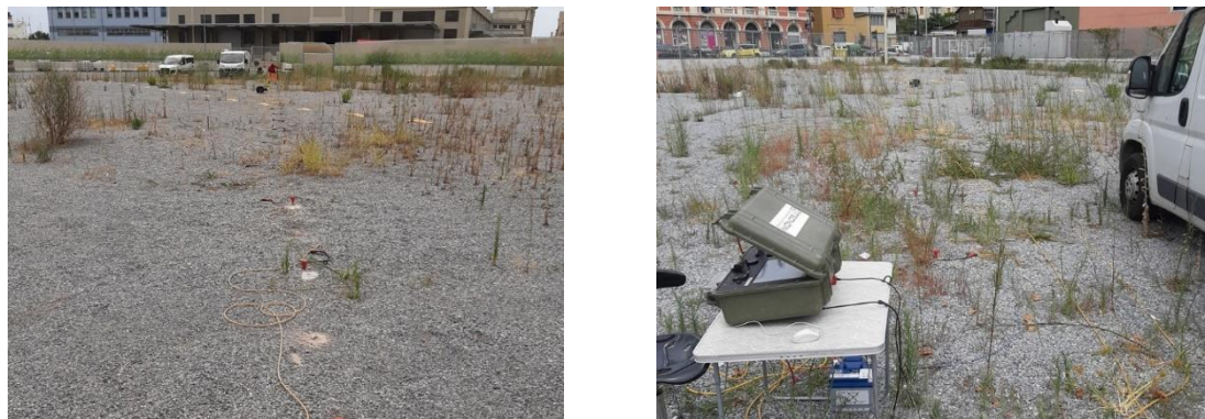
Figura 134. Foto indagine MASW sottostazione di "via Merano".
